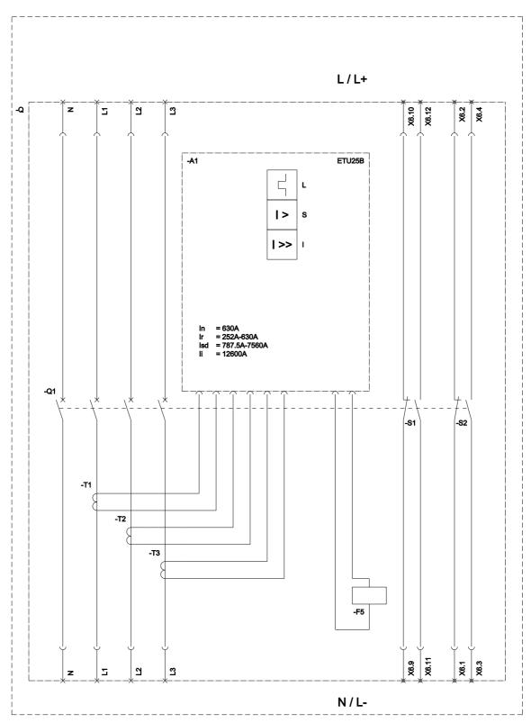
L (Long Time Delay / Überlastschutz); S (Short Time Delay / Kurzschlussschutz, kurzzeitverzögert); I (Instantaneous / Kurzschlussschutz, unverzögert); F5 (Maglatch for trip unit / Auslösemagnet); S1 - S8 (Auxiliary switch / Hilfsschalter);
